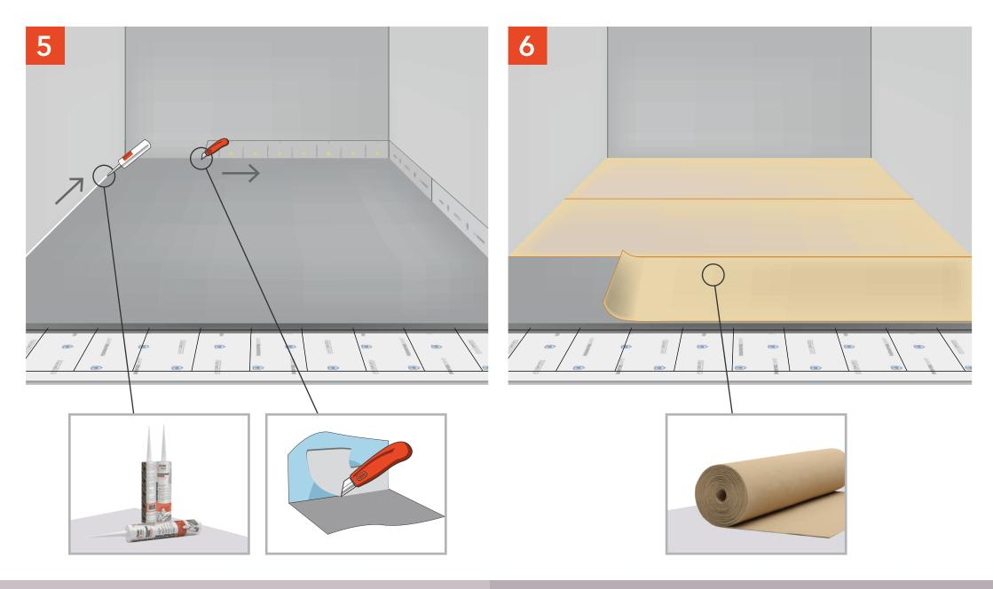
Обрезаем излишки ТермоЗвукоИзола и желательно заполняем пространство виброакустическим герметиком Сонетик.
