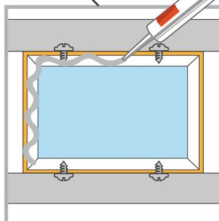
Наклеиваем уплотнительную ленту DB на поверхность профиля, заполняем пространство шумопоглощающими плитами.
