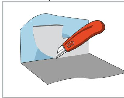
Обрезаем излишки Звукоизол ВП и желательно заполняем пространство виброакустическим герметиком Сонетик.
